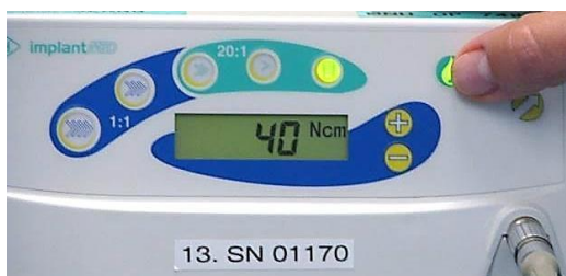
Figura 33: Configuración del taladro para insertar el implante.
