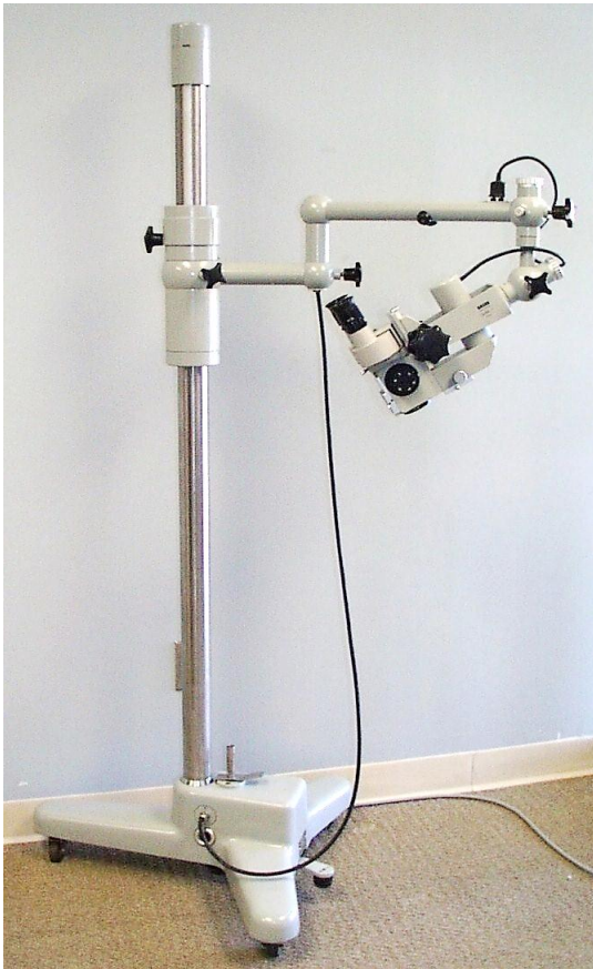
Figure 1 : Modèle plus ancien d'un microscope opératoire Zeiss (OPMI-1) avec ampoule à incandescence
