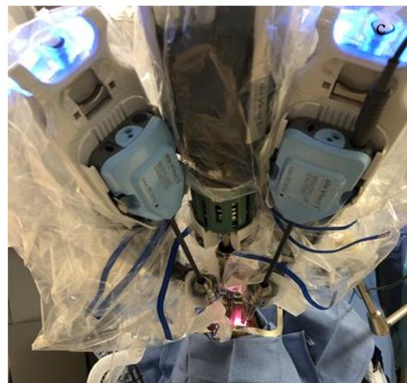
*Figures 3 b,c: Chariot patient : le robot chirurgical apparaît avec une housse stérile*
