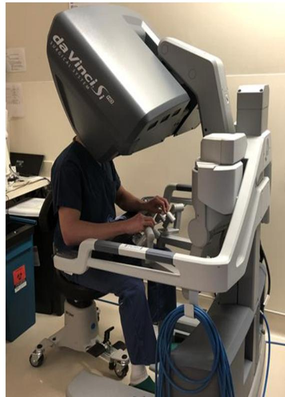
*Figure 1 : Le chirurgien est assis à une console séparée et dirige les mouvements des bras robotiques et des instruments chirurgicaux*
