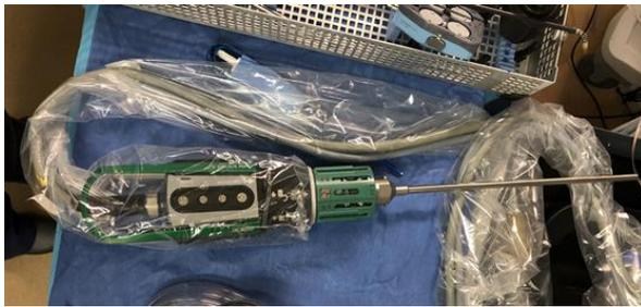
Figure 6 : Endoscope robotisé à 0 degré dans une housse stérile
