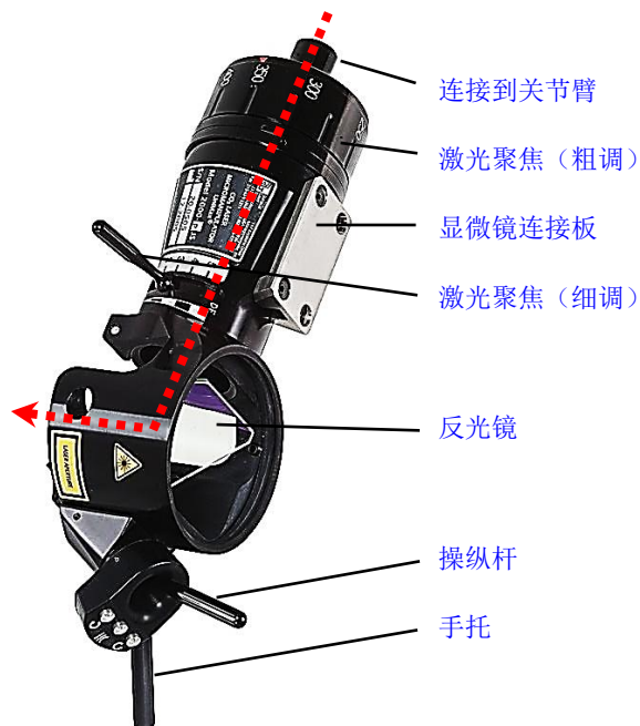
图 5：微操作器示意图（红色虚线表示激光束路径）
