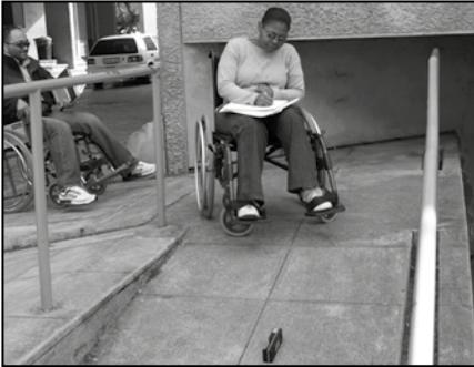
(a) Ramp gradient measurement<sup>5</sup>
